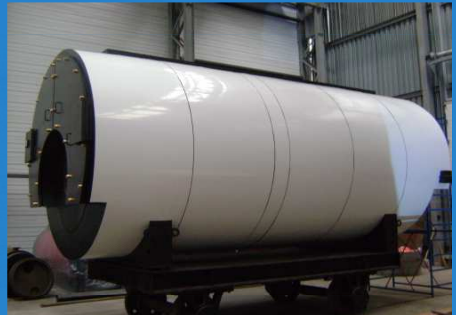
Водогрейный котел «FR10-8-16-204» (8,0 МВт, масса – 24 тонны) на территории производственного корпуса готовый к отгрузке на ж/д платформу
