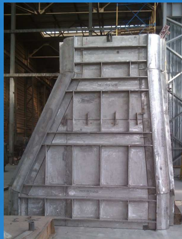
Диффузор котла- утилизатора Челябинской ТЭЦ-1.
