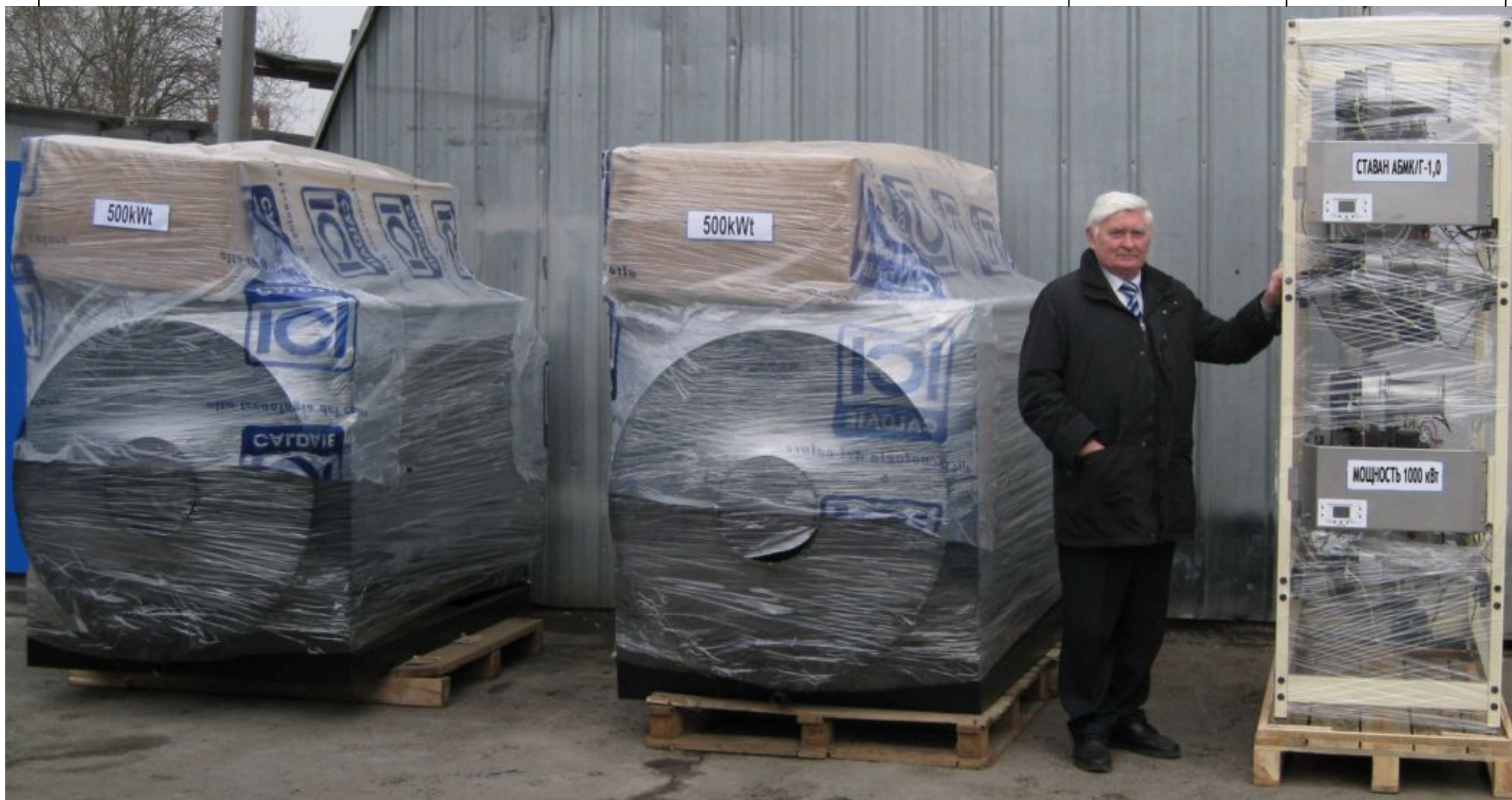
Сравнительные габаритные размеры двух стандартных котлов 2x500кВт и одного котлоагрегата «Ставан - АБМК» 1000кВт
