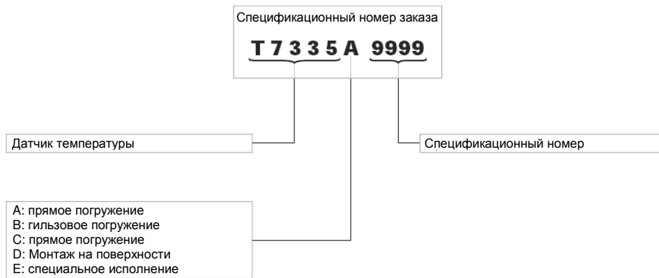
Рис. 11. Схема формирования номера модели термисторного датчика температуры T7335
